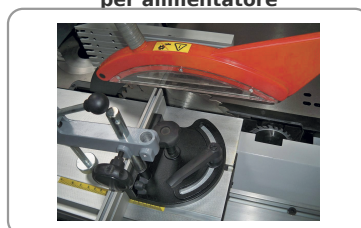
Carrello a filo lama 2000 mm, lama Ø 315 o Ø 250 mm, incisore Ø 100 mm
