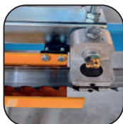
Guide de lame avec buse pour liquide de refroidissement
