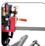
Guidage de lame ajustable et très précis par roulements 8 points
