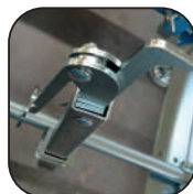
Griffe de maintien à serrage excentrique
