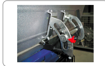
Guía de perfil de aluminio con inclinación de 45°
