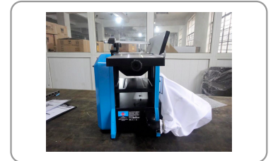
Sistema de aspiración integrado (con bolsa de recogida de virutas)
