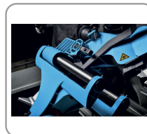
Cabezal con deslizamiento radial
