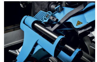
Cabezal con deslizamiento radial
