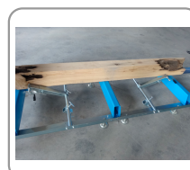
Sistema de retención de troncos
