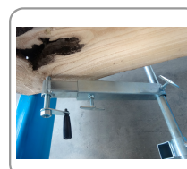
Sistema de retención de troncos
