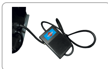
Control de marcha/parada mediante pedal
