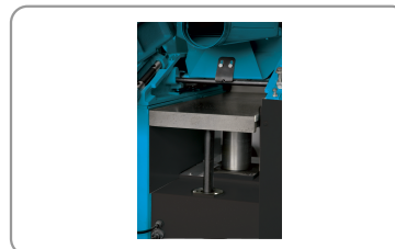
Mesa de cepillado montada sobre 2 ejes
