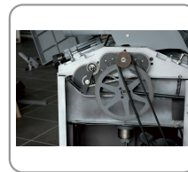
Accionamiento mediante cadena, accionamiento del motor con doble correa
