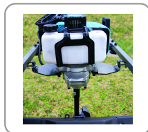
Montage du bloc moteur sur pivots
