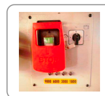
Tupí con 4 velocidades de rotación
