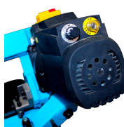
Variador de velocidad, botón de rearme, indicador de conexión
