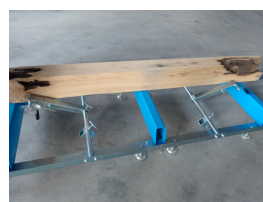
Sistema de retención de troncos
