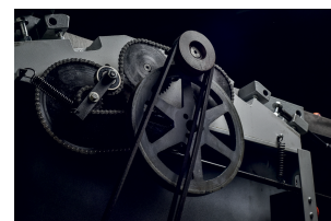
Rodillos accionados por cadena, accionamiento por motor de doble correa
