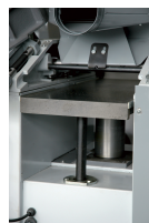
Mesa de cepillado montada sobre 2 ejes
