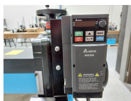
Onduleur delta permettant de régler la vitesse de rotation du cylindre
