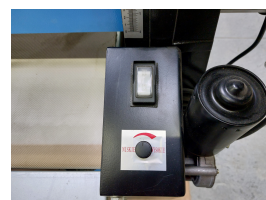
Moteur et boutons de commande indépendants pour le tapis de convoyage
