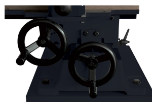
Doble carro lateral y longitudinal en cola de milano
