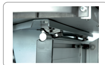
Carro de ranuración con deslizamiento sobre rodamiento de bolas
