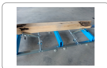
Sistema de retención de troncos
