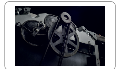
Rodillos accionados por cadena, accionamiento por motor de doble correa
