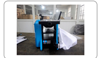
Sistema de aspiración integrado (con bolsa de recogida de virutas)
