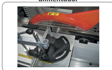
Carro junto a la hoja de 2000 mm, hoja Ø 315 o Ø 250 mm, incisor Ø 100 mm
