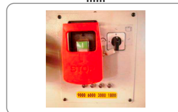
Tupí con 4 velocidades de rotación
