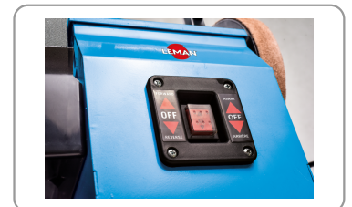
Interruptor marcha/parada con selección del sentido de rotación
