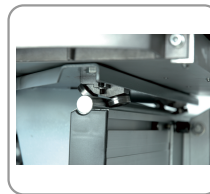
Chariot de tenonnage avec coulissement sur roulements à billes
