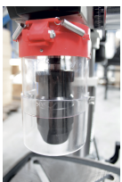
Carter de mandrin basculant et réglable
