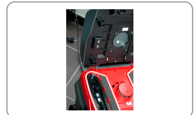
Décolmatage automatique et électromagnétique des filtres par impulsion
