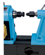
Broche d'entraînement filetée m33 x 3.5 mm
