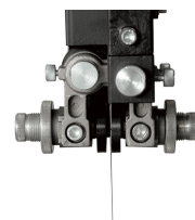
Guide de lame supérieur et inférieur à galets
