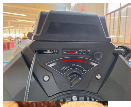
Moteur de 25 cv à démarrage électrique
