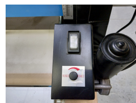
Moteur et boutons de commande indépendants pour le tapis de convoyage
