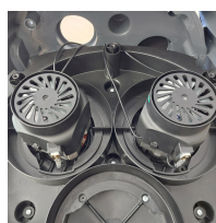
2 moteurs à refroidissement by- pass montés en parallèle
