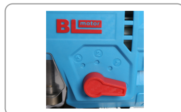
Mouvement pendulaire à 4 positions.
