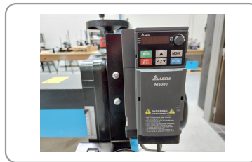
Onduleur delta permettant de régler la vitesse de rotation du cylindre
