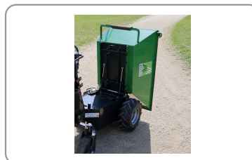
Benne à basculement manuel assisté par vérins à gaz
