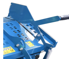
Protecteur supérieur avec poignée réglable et griffe de maintien de la bûche
