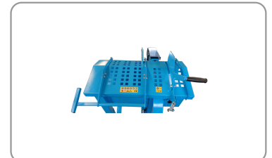
Protecteur supérieur avec poignée réglable et griffe de maintien de la bûche
